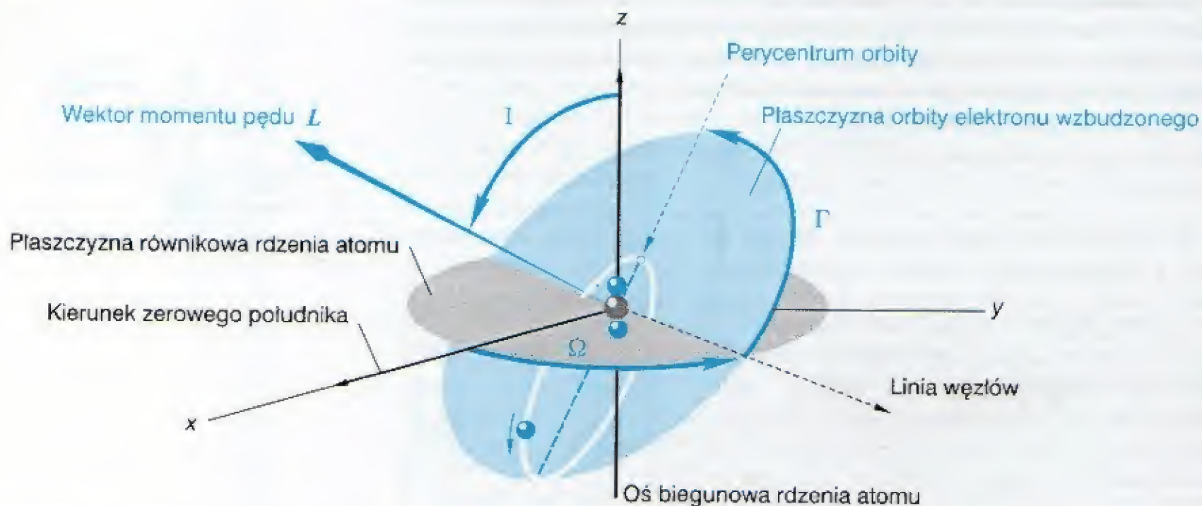
Rys.2. Eliptyczna orbita w przestrzeni. Jej orientację w prostokątnym układzie współrzędnych xyz określają trzy kąty: I , \Omega , \Gamma . I jest kątem pomiędzy płaszczyzną orbity a płaszczyzną xy laboratoryjnego układu współrzędnych, \Omega jest kątem, jaki tworzy linia przecięcia się tych płaszczyzn, zwana linią węzłów, z osią x -ów, a \Gamma jest kątem, jaki tworzy ta linia węzłów z główną osią elipsy.
