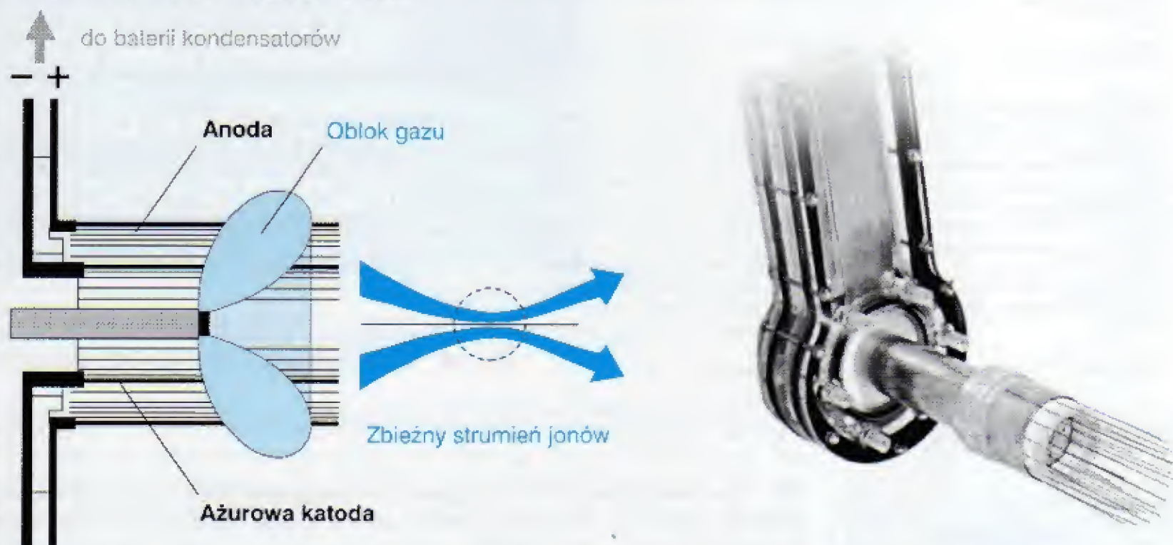
Rys.2. Pierwszy etap podjętych w 1959 roku badań nad kontrolowaną syntezą jądrową: na lewo – koncepcja urządzenia do wytwarzania silnych zbieżnych strumieni jonów (tak zwane działo prętowe); na prawo – fotografia pierwszego działka prętowego, punkt wyjścia dla programu SOWA.
